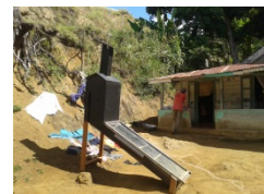
Exemple de séchoir solaire
